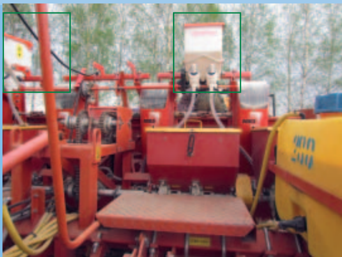
Аппликатор для внесения инсектицида РЕГЕНТ® 20G, установленный на картофелесажалку СК-4
